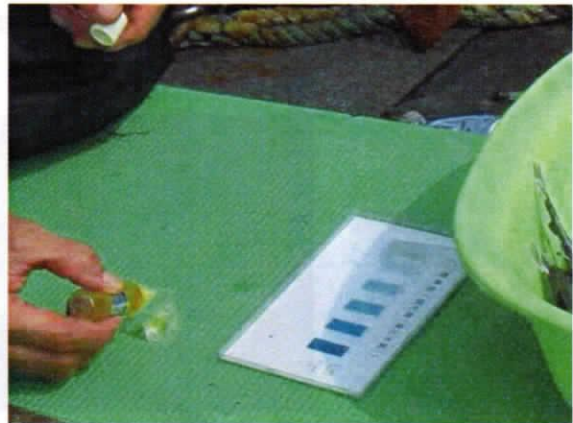
図6 採取サンプルは直ちに、サンプルカップに移しバックテストの手順に従い発色させる。スポイトから取り出し他サンプルはできる限り短い時間で分析操作を行う。
