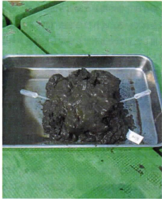
図4 エクマンバージ採泥器採取サンプルからの採水
