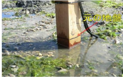
ヘドロ(有機物)が分解され、地盤が3.5cm下がった。対照区は変化なし。
